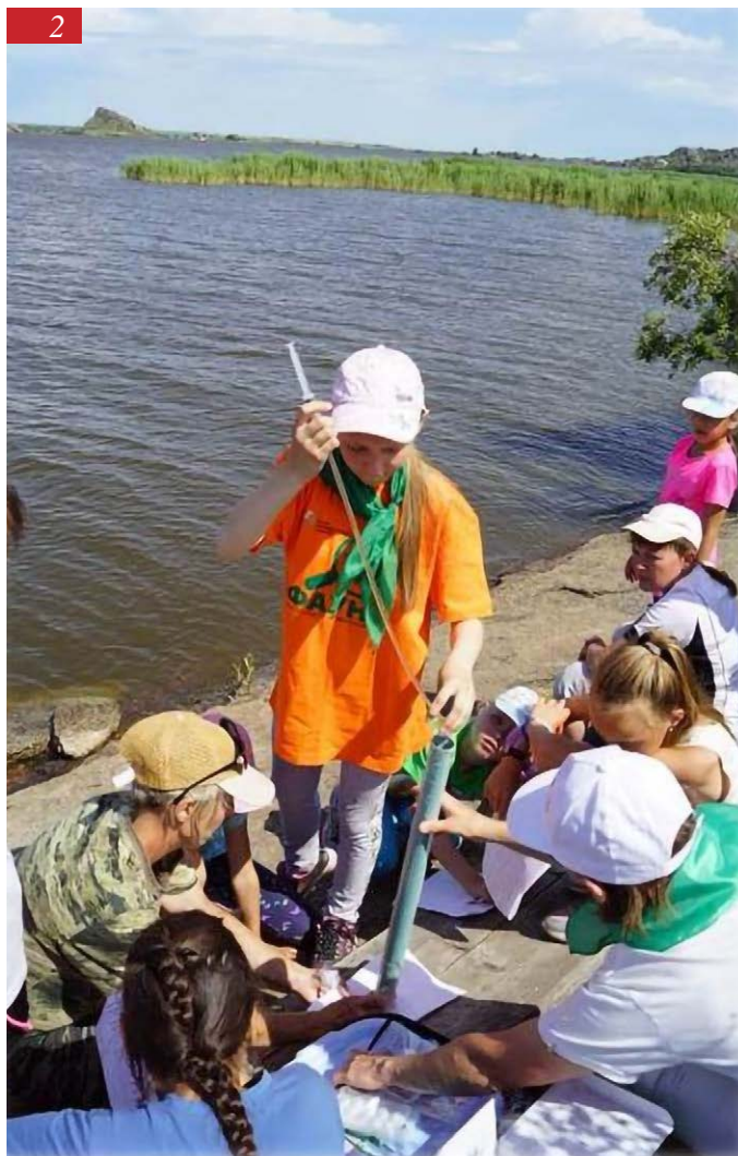
Рис. 2. Определение мутности и прозрачности воды с помощью мутномерной пробирки
