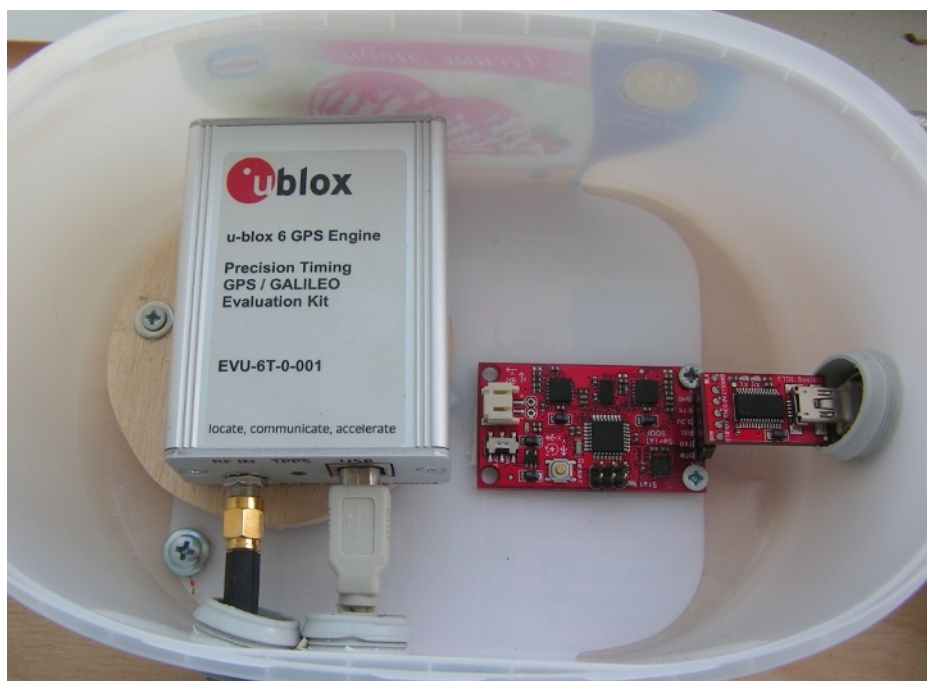
Рис. 4: Приёмник спутниковой навигации Ublox Antaris LEA-6T и инерциальный датчик Sparkfun 9DOF.
