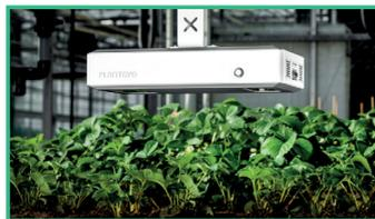
Современные решения компании PHENOSPEX позволяют проводить комплексный анализ морфологических и спектральных характеристик растений в различных условиях окружающей среды.
